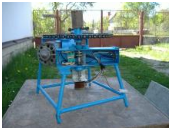
obr. 2 rotátor - pohled na hřídel unášeče a koncové vypínání
