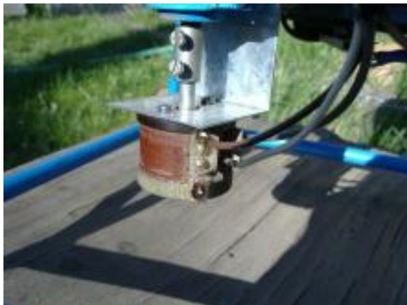
obr. 3 detail snímače polohy natočení
